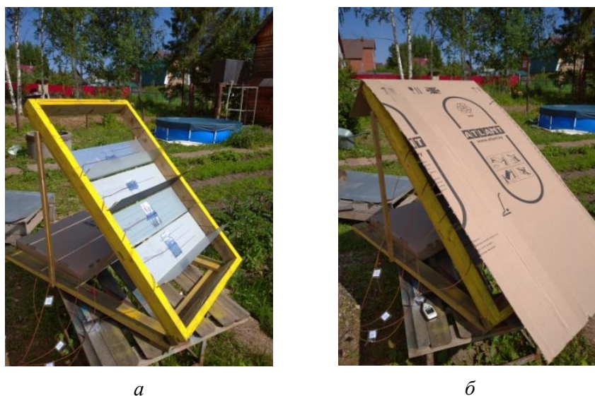
Рис. 2. Черные карнизы в тени, эксперимент № 4: a – открытый карниз; б – карниз, закрытый картоном Fig. 2. Black cornices in the shade, experiment No. 4: a – open cornice; б – cornice covered with cardboard
