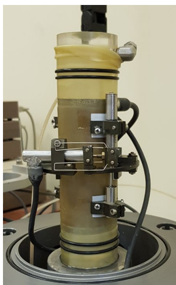
Рис. 5. Образцы грунта, оборудованные системой измерения локальной деформации в камерах трехосного сжатия
