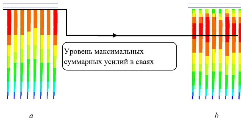
Рис. 3. Характер распределения максимальных усилий в сваях:  $a$  – для свайно-плитного фундамента с жесткой заделкой свай;  $b$  – для свайного фундамента с ПРС
