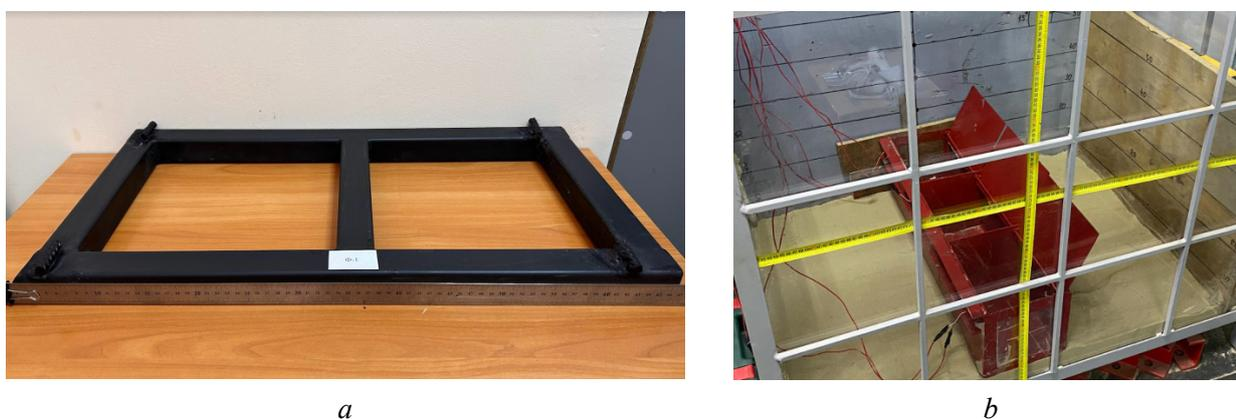
Рис. 1. Модель фундамента, карстовой полости: *a* – модель перекрестно-балочного фундамента, *b* – модель карстовой полости
