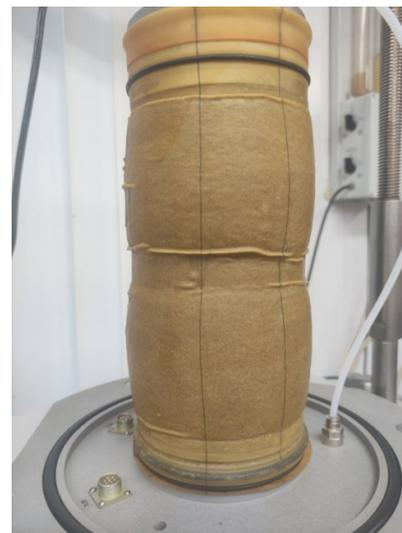
Рис. 8. Образец, армированный в средней части двумя элементами с расстоянием между ними 16 мм после окончания испытания
