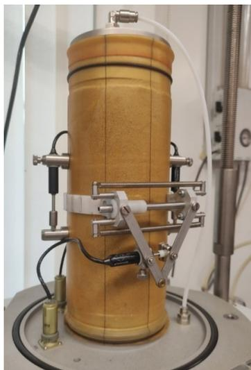
Рис. 7. Сформированный образец грунта для испытания на определение угла трения на контакте геотекстиля с грунтом
