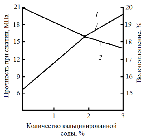
Рис. 3. Влияние количества кальцинированной соды на прочность при сжатии (1) и водопоглощение (2) керамического кирпича, обожженного при температуре 1000 °С
