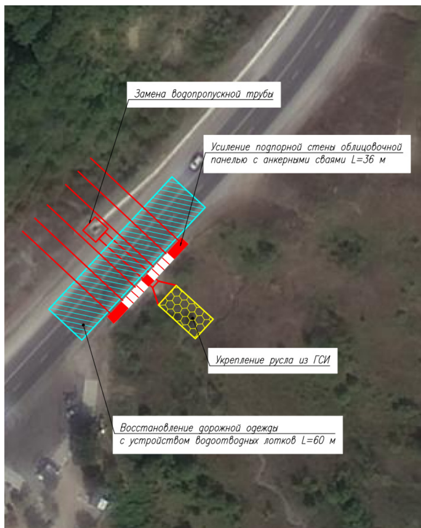
Рис. 8. План расположения мероприятий по усилению подпорной стены
