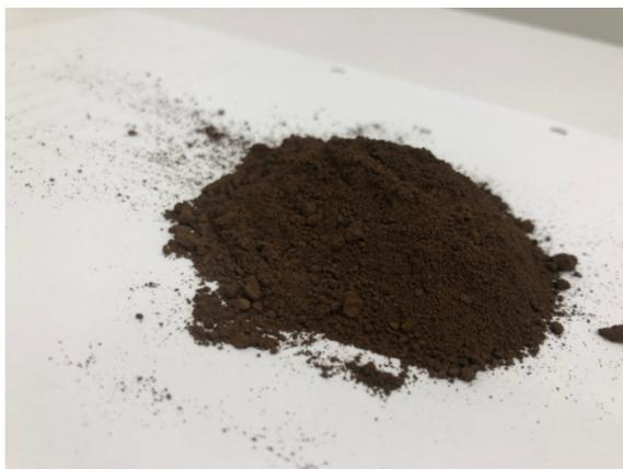
Рис. 3. Пыль газоочистки дуговой электросталеплавильной печи
