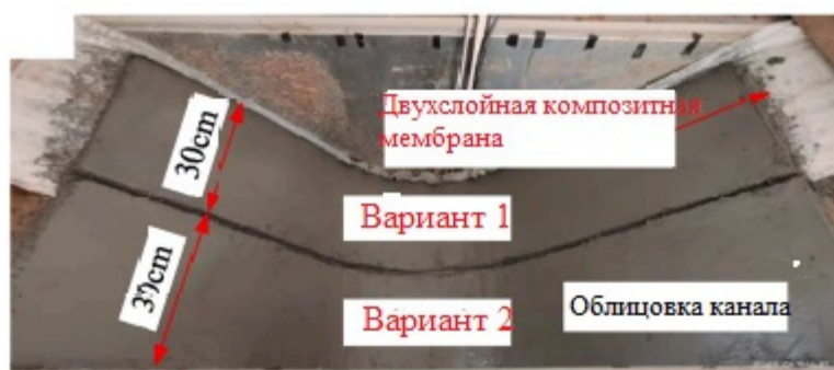
Рис. 8. Модель канала после строительства облицовки по Н. Jiang [44]
