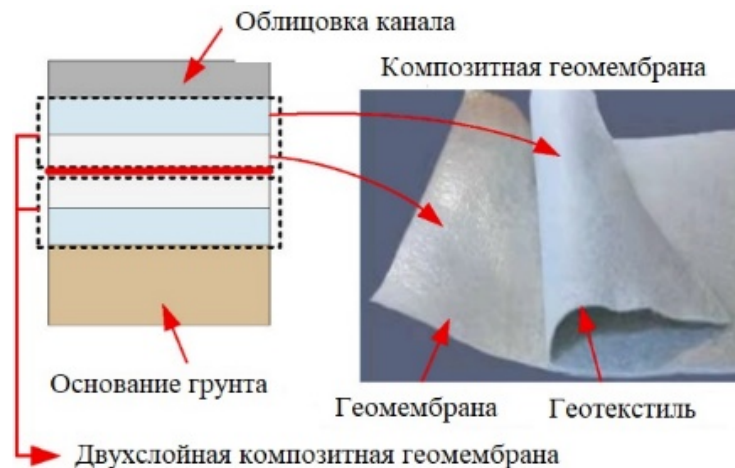
Рис. 7. Двухслойная композитная геомембрана по Н. Jiang [49]
