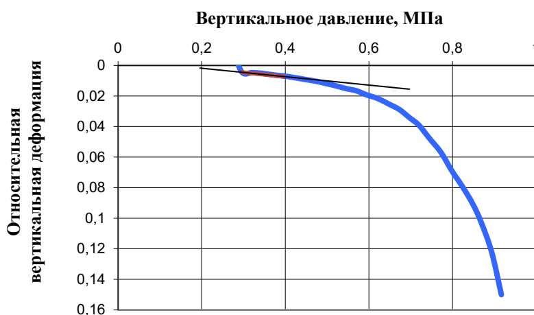
Рис. 5. Зависимость девиаторного напряжения от вертикальной деформации
