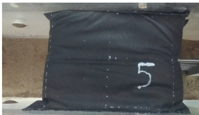
Рис. 3. Модель геосинтетической оболочки для проведения испытаний Fig. 3. Model of the geosynthetic shell for testing
