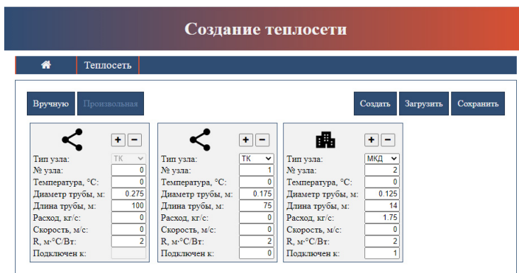
Рис. 2. Генерация топологии теплосети вручную
