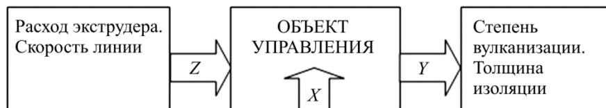
Рис. 3. Схема процесса вулканизации как объекта управления:
