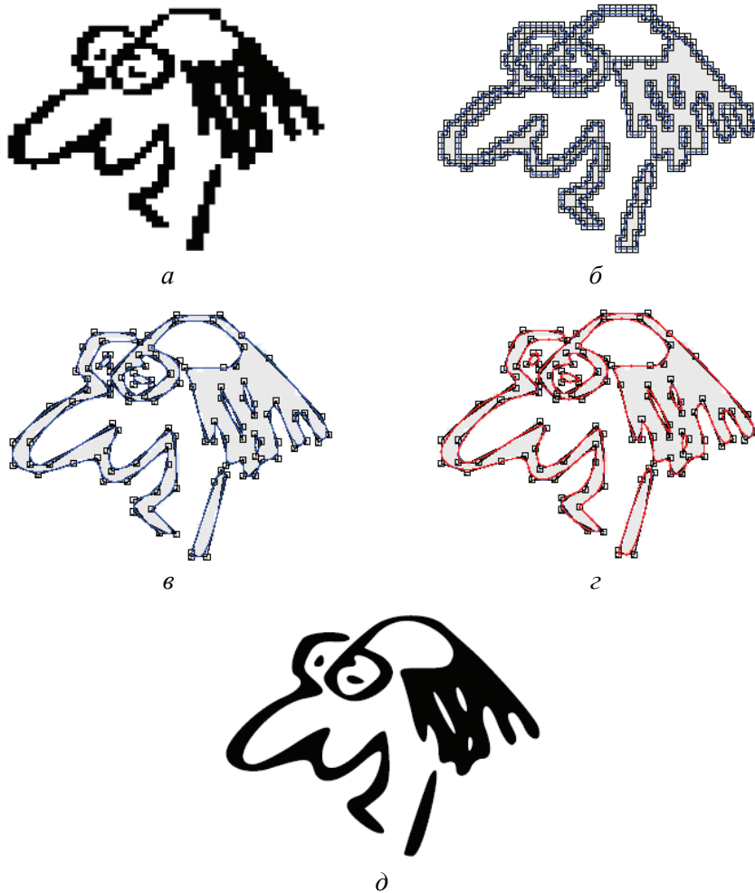
Рис. 5. Пример окончательного результата алгоритма программы: а – первоначальный точечный рисунок; б – декомпозиция пути и оптимальный многоугольник; в – настройка вершины, анализ угла, и сглаживание; г – оптимизация кривых; д – конечный результат
