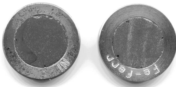
Рис. 1. Общий вид нуля-эталонов железа и никеля
