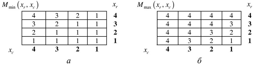
Рис. 5. Матрицы свертки:  $a$  – с минимально возможными элементами  $d_{rc}$ ;  $b$  – с максимально возможными элементами  $D_{rc}$
