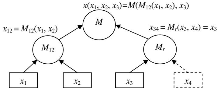
Рис. 3. Пример трехфакторного ММКО, эквивалентного четырехфакторному при  $M_{34} = M_r$  [см. выражение (18)]
