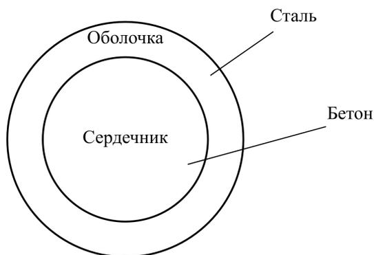
Рис. 1. Сечение трубобетонной колонны
