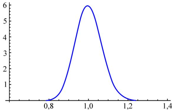
Рис. 2. Распределение безразмерной жесткости стержня на кручение при  $\sigma_a = 0,015$ ,  $\sigma_u = 0,03$
