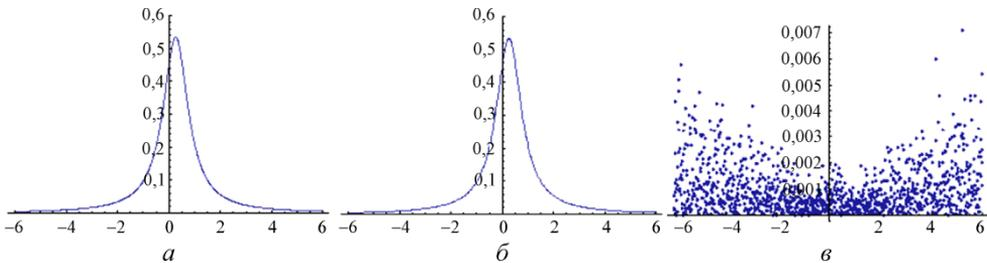
Рис. 1. Плотность распределения частного нормально распределенных случайных величин при  $\sigma_1 = 1,3$ ;  $\sigma_2 = 2,0$ ;  $r = 0,4$ : а – численное решение; б – аналитическое решение; в – относительная погрешность численного решения
