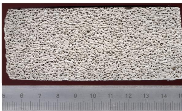
Рис. 6. Образец автоклавного газобетона
