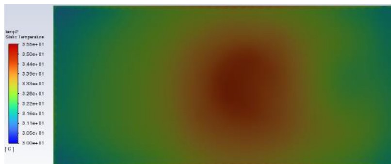
Рис. 19. Поле распределения температур на внутренней оболочке потолка камеры
