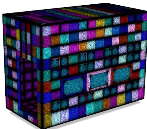
Рис. 12. Внешний вид расчетной сетки ограждающей конструкции
