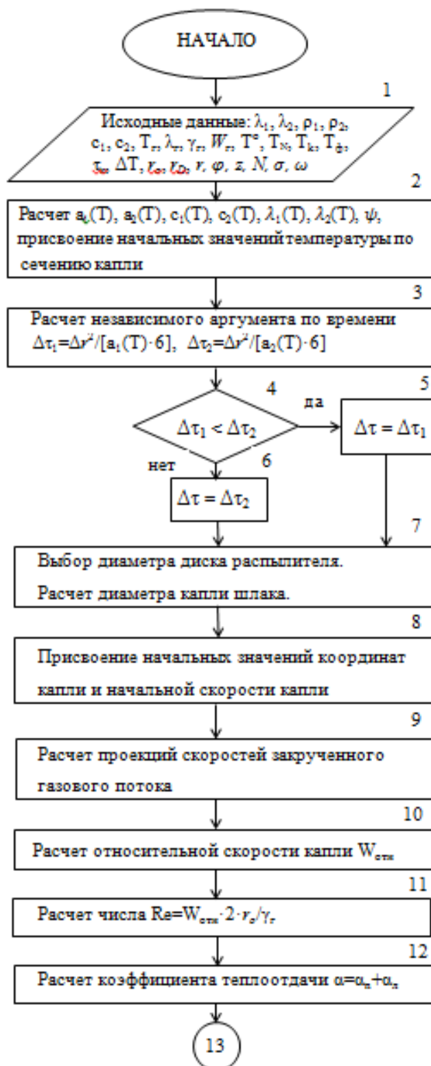
Рис. 4. Блок-схема алгоритма расчета теплообмена капли доменного шлака в закрученном потоке охлаждающего газа
