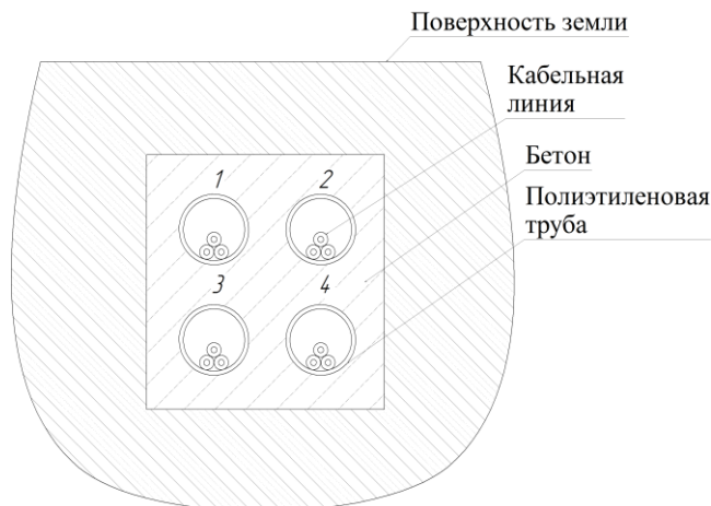
Рис. 1. Конструкция подземного кабельного канала
