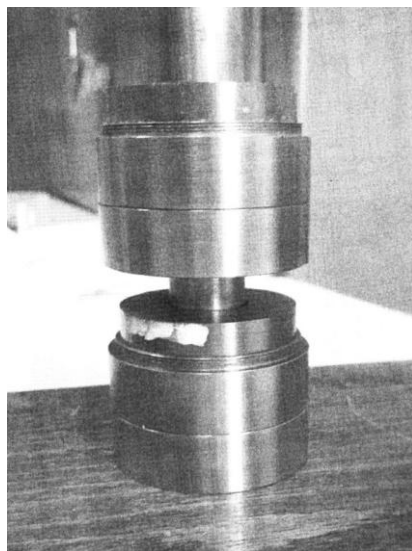
Рис. 8. Секция вторичного элемента с магнитами в сборе
