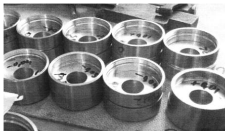
Рис. 6. Полюса и промежуточные кольца вторичного элемента
