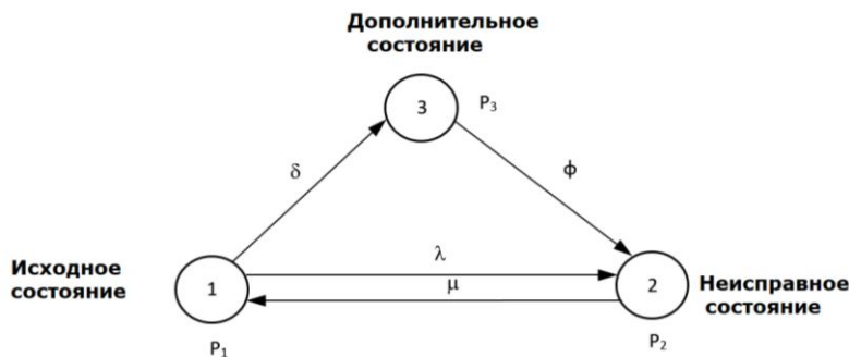
Рис. 5. Граф марковского процесса для одного дополнительного состояния готовности ПЛИС P_3 за счет восстановления из отказавших элементов
