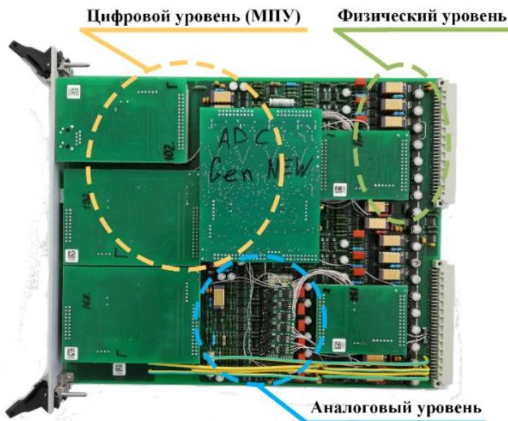
Рис. 2. Внешний вид экспериментального образца СПП моделирования энергоблока, где МПУ – микропроцессорный узел
