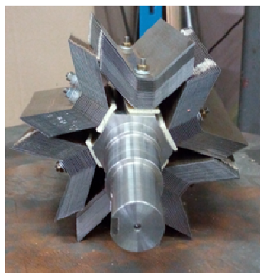
Рис. 2. Заготовка ротора реактивной электрической машины с анизотропной магнитной проводимостью со скосом полюсов ротора (до компаундирования и проточки)
