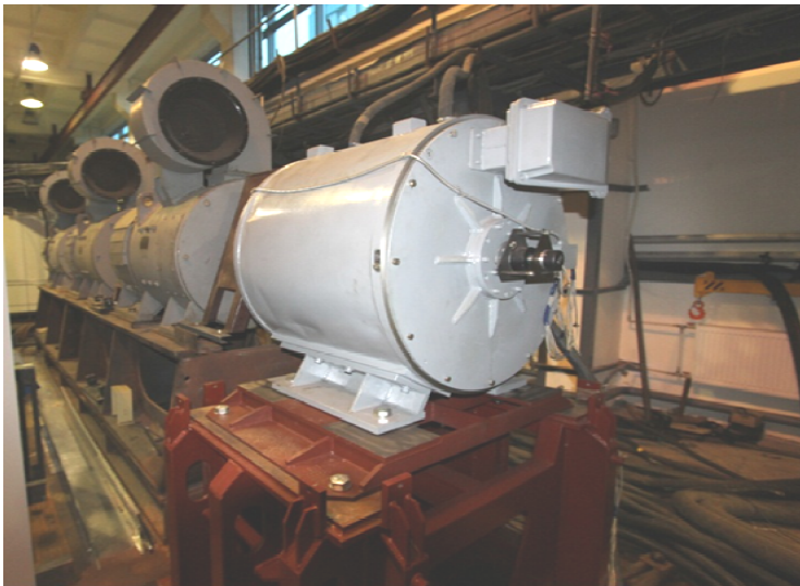
Рис. 10. Исследовательский стенд опытного образца РЭМАПР
