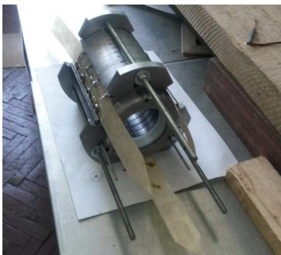
Рис. 4. Вариант индуктора с тремя симметричными пазами, каждый под свою фазу
