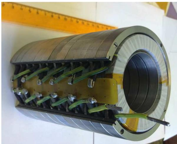
Рис. 3. Вариант индуктора с одним пазом под трехфазную обмотку
