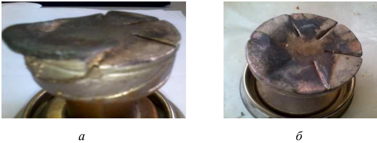
Рис. 2. Типичная деформация контактной поверхности элемента вакуумного выключателя (асимметрия действия «трубки» мощного тока на контактную поверхность сечения расслоения)
