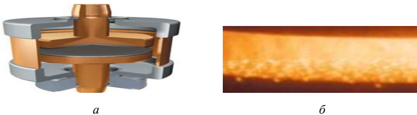
Рис. 1. Фрагмент подобия типичной конструкции в состоянии «отключено» (слева) и фрагмента (справа) сечения расслоения «трубки» тока контактного пространства вакуумного выключателя ВВ/TEL [11] в момент динамического разрыва непосредственного контакта поверхностей элементов пары
