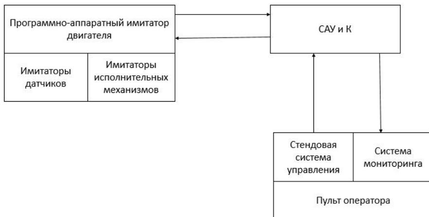
Рис. 2. Структурная схема стенда для полунатурных испытаний систем автоматического управления и контроля
