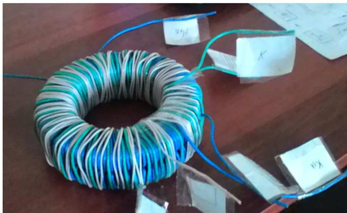
Рис. 7. Прототип умножителя частоты в 4 раза на основе аморфного сплава 1-СП
