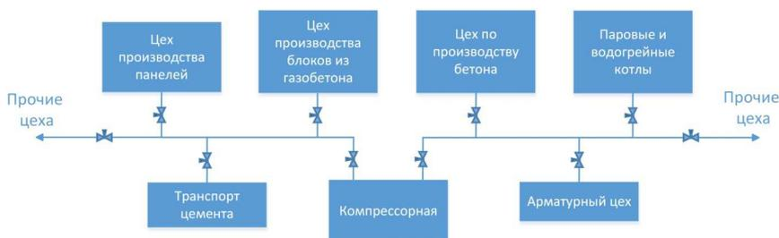
Рис. 1. Схема распределения сжатого воздуха на АО «ПЗСП»
