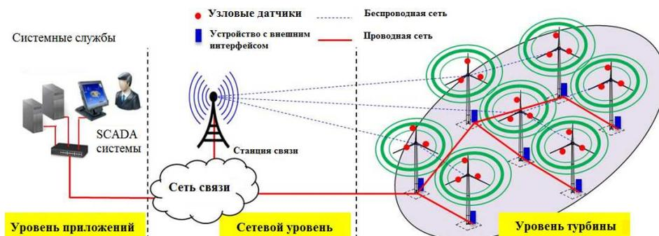
Рис. 1. Умные ветровые электростанции. SCADA-системы диспетчерского управления и сбора данных
