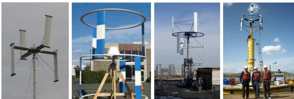
Рис. 3. Четырех- и шестилопастные двухъярусные ВЭУ мощностью 3 кВт с размещением на парковках, зданиях и инженерных сооружениях (морской буй)
