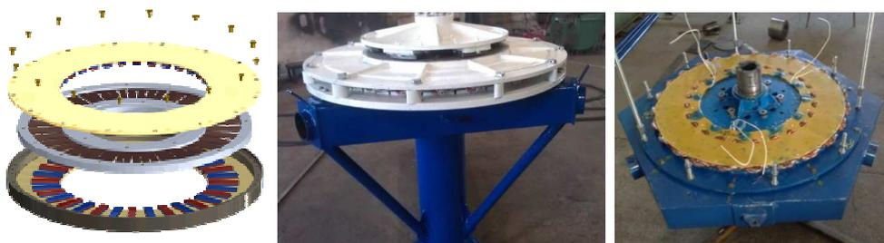
Рис. 7. Генератор ВЭУ (схема, внешний вид и вид якорной обмотки)
