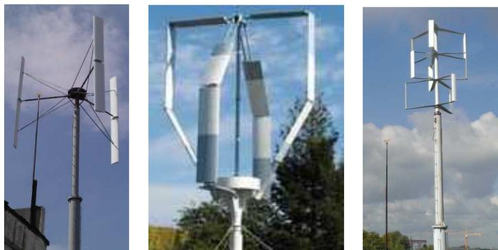
Рис. 2. Трех-, четырех- и девятилопастные многоярусные микро-ВЭУ мощностью 1 кВт
