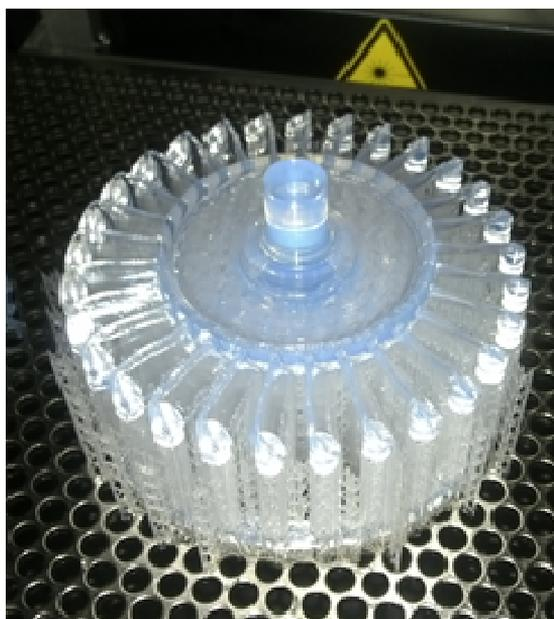
Рис. 3. Выжигаемая модель колеса турбины
