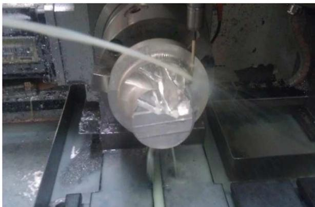
Рис. 2. Изготовление колеса компрессора
