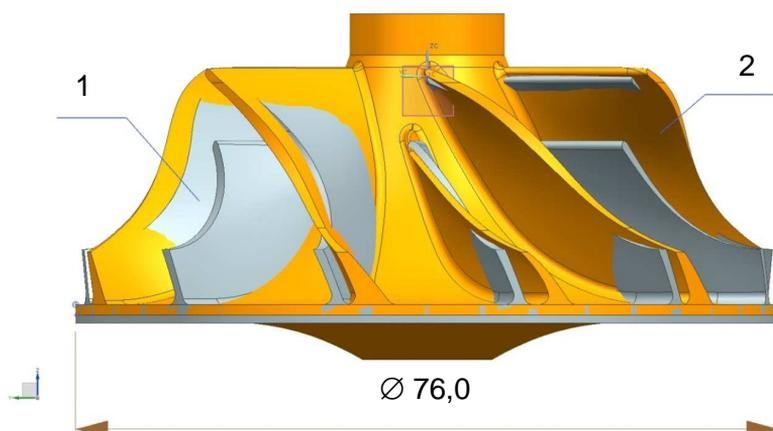
Рис. 1. Сравнение рабочих колес теоретического 1 и прототипа 2
