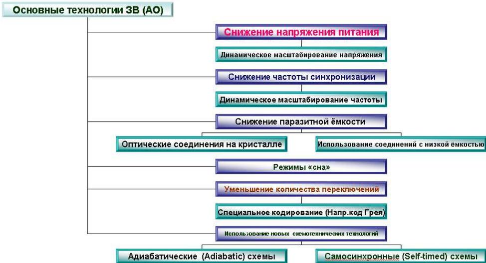
Рис. 7. Основные технологии ЗВ относительно аппаратного обеспечения (АО)
