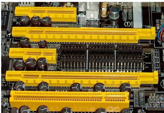
Рис. 13. Шина 4 PCI Express (bus card slots)
