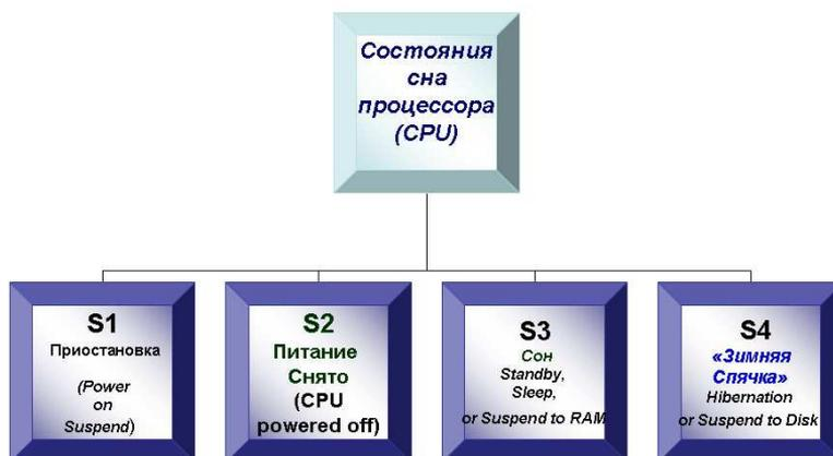
Рис. 18. Состояния «сна» процессора
