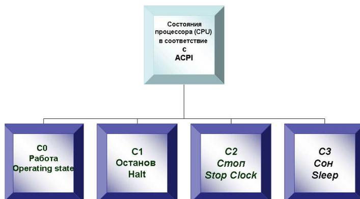
Рис. 17. Четыре состояния функционирования процессора
