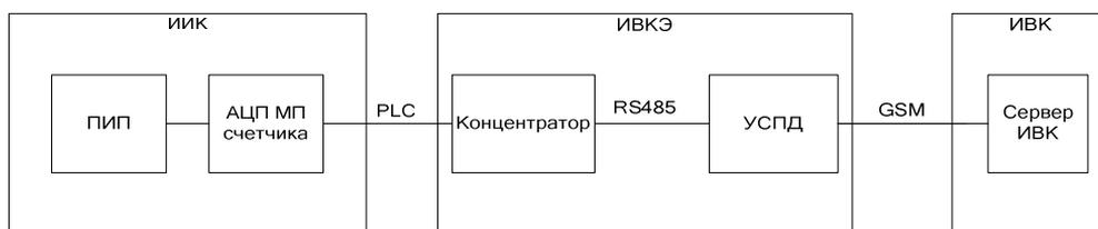
Рис. 5. Схема измерительного канала
