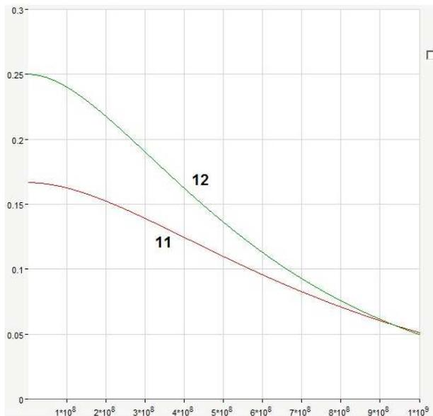
Рис. 4. Сравнение избыточных транзисторных структур, парирующих однократные отказы (сбои) по показателю ВБР/сложность
