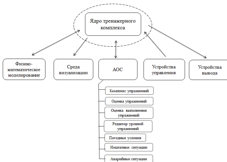
Рис. 2. Архитектура программного обеспечения тренажерного комплекса
