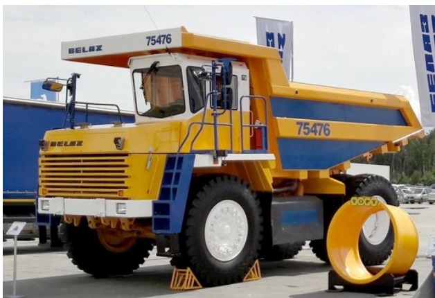
Fig. 2. Mining tipper truck BelAZ-75476 on LNG
