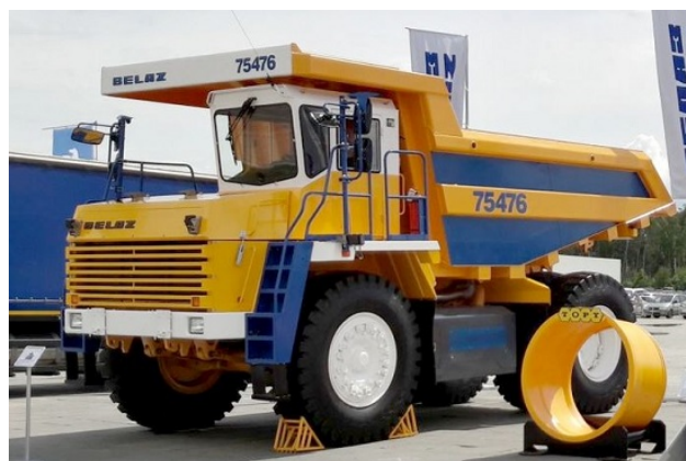
Рис. 2. Карьерный самосвал БелАЗ-75476 на СПГ
