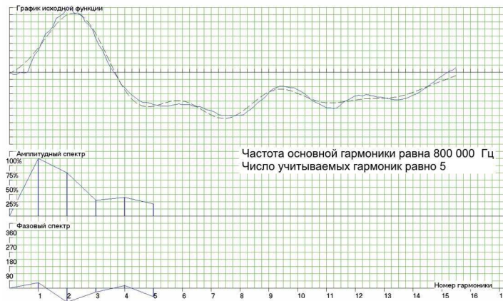
Рис. 2. Синтез функции без учета знаков коэффициентов a и b при определении начальных фаз: a – по выражению (2); b – по выражению (1)
