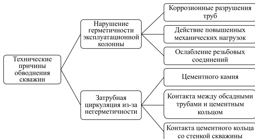
Рис. 2. Классификация технических причин обводнения скважин
