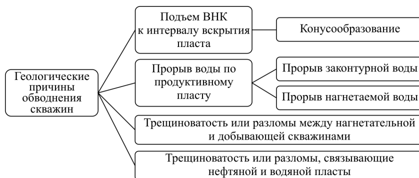
Рис. 3. Классификация геологических причин обводнения скважин
