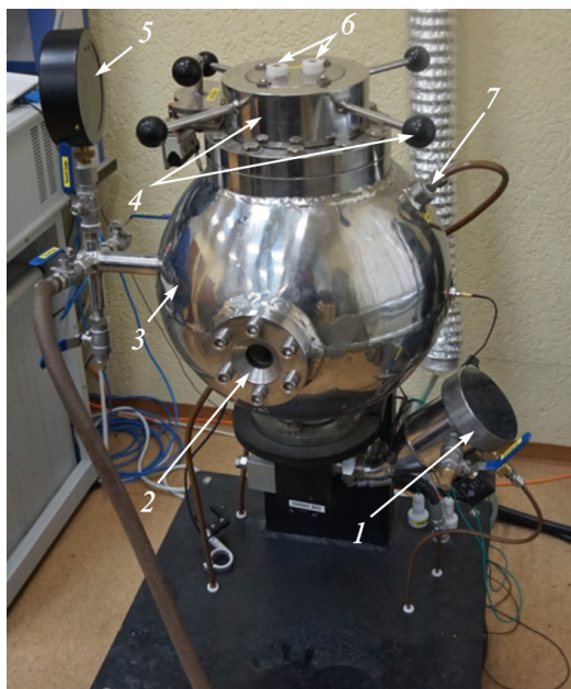
Рис. 1. Внешний вид установки: 1 – загрузочное устройство (пылеотборник объемом 0,6 дм 3 ); 2 – смотровое окошко; 3 – рабочая камера с внутренним объемом 20 л; 4 – держатели и запорный механизм 20-литровой сферы (рабочей камеры); 5 – манометр; 6 – токопроводы (держатели химического воспламенителя); 7 – выходное отверстие воды
