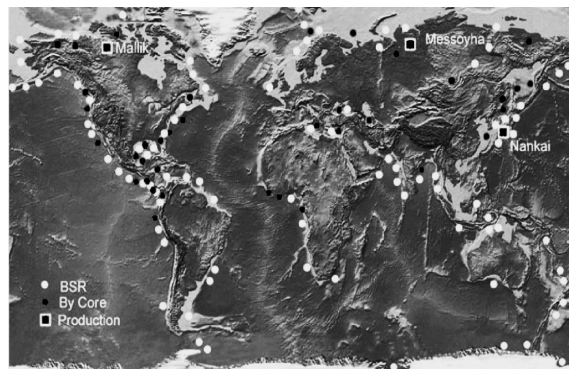
Рис. 9. Континентальные и субаквальные проявления газов и гидратов: BSR – предполагаемые газогидратные залежи; By Core – подтвержденные газогидратные залежи; Production – разрабатываемые газогидратные залежи; Mallik – газовое месторождение в дельте р. Маккензи, Канада; Messoyna – газогидратное месторождение, расположенное на северо-востоке Западной Сибири, на 250 км западнее г. Норильска; Nankai – газогидратное месторождение на шельфе Японии в районе восточного Нанкайского прогиба
