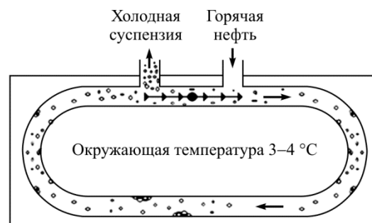
Рис. 6. Схематичное изображение аппарата «Поглотитель парафина»
