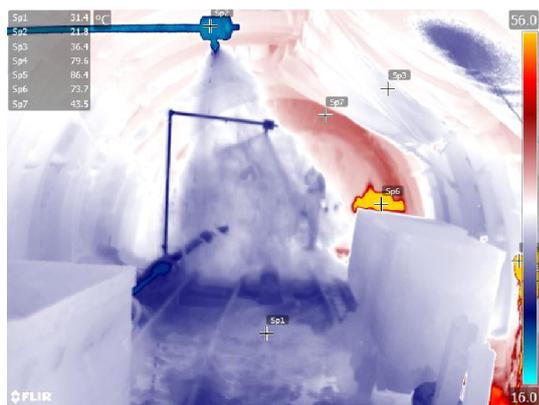
Рис. 5. Термоснимок системы орошения, установленной в эксплуатационной галерее
