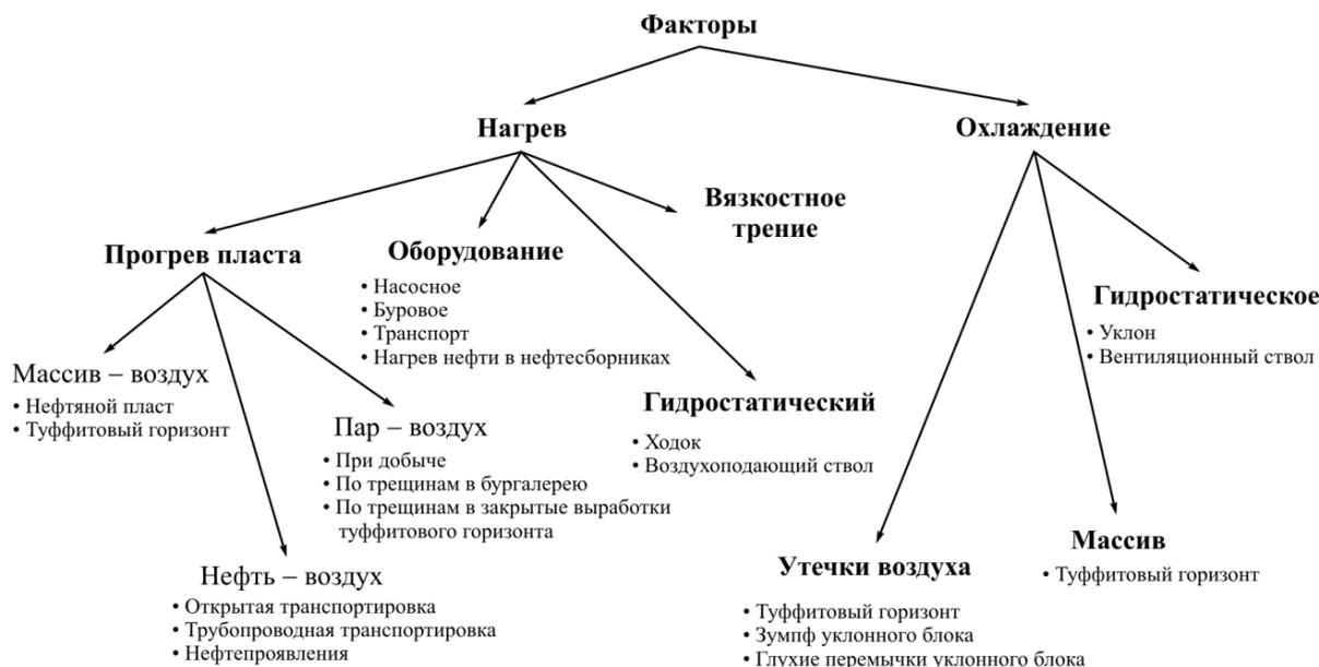
Рис. 7. Классификация факторов формирования микроклимата в нефтяной шахте
