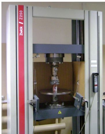
Рис. 5. Вид испытательной машины Zwick/Z250
