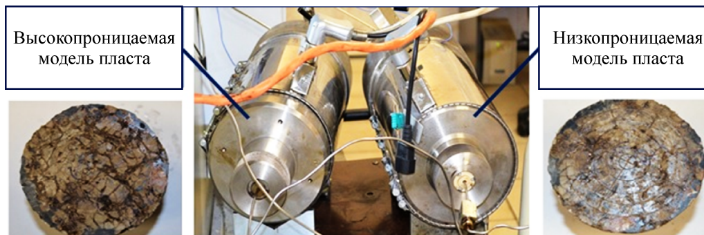
Рис. 4. Общий вид двухслойной модели пласта
