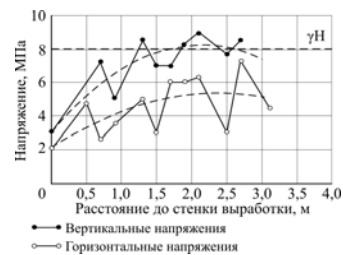
Рис. 4. Распределения напряжений в междукамерном целике с удалением от контура
