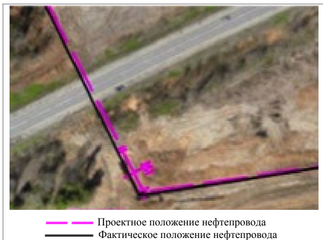
Рис. 6. Расхождение проектного положения нефтепровода от фактического
