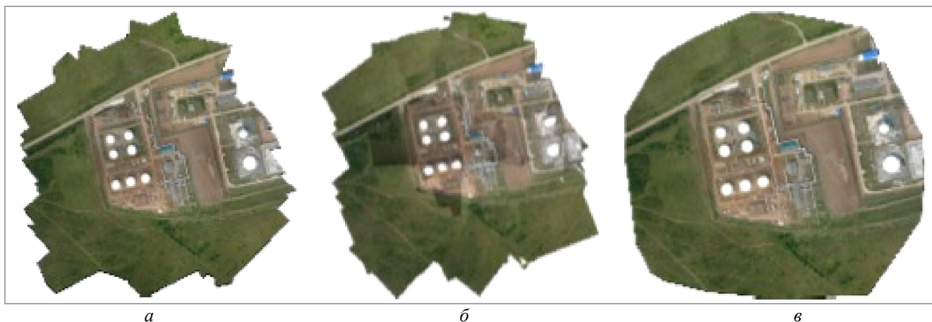
Рис. 3. Вид готового ортофотоплана, полученного в программном продукте: а – Agisoft Photoscan Professional, v 1.2.5.2594; б – ERDAS IMAGINE, v 2015; в – Pix4Dmapper Pro
